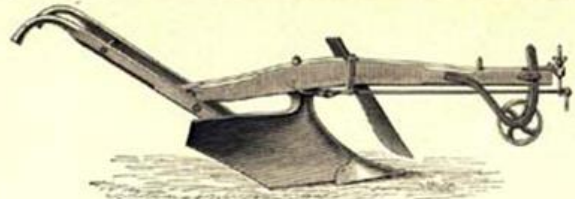
Fig. 1. Amerikanischer Pflug, Stellwender mit Stelzrad.
