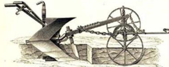
Fig. 6. Keilpflug von Saak mit zwei um eine horizontale Achse drehbaren Pflugkörpern.
