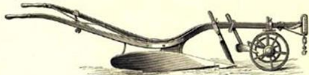
Fig. 2. Englischer Pflug, Flackwender mit Rädern.
